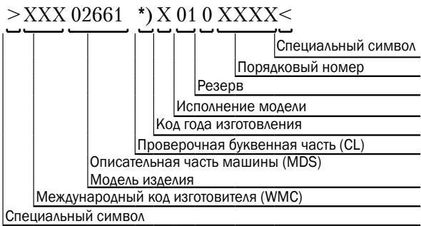
Рисунок 2.4 — Маркировочная табличка машины и расшифровка идентификационного номера форвардера АМКОДОР 2661-01 *) Проверочная буквенная часть (CL) рассчитывается математически или используется буква N без расчета
