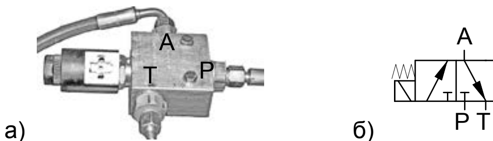
Рисунок 3.64 — Клапан электроуправляемый: а) общий вид; б) принципиальная схема
