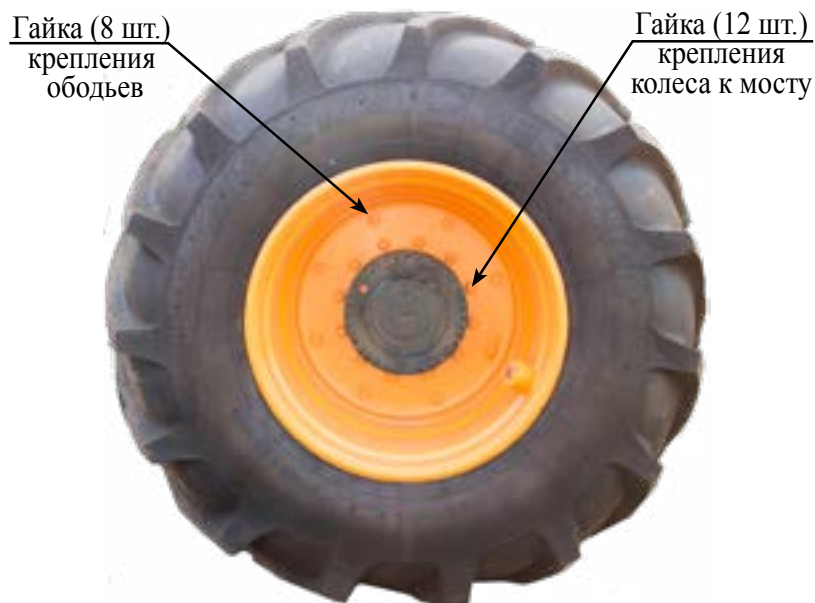
Рисунок 3.29 — Схема затяжки гаек крепления ободьев передних колёс
